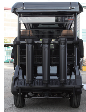
ㄱ 롱데크 적재 1,435mm ㄴ (숏데크 적재 815mm) 롱데크 전장 3,450mm (숏데크 전장 3,550mm)
