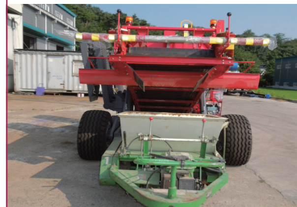
그린 배토기에 배토사 공급 / 정밀 공급용 가이드 설치
